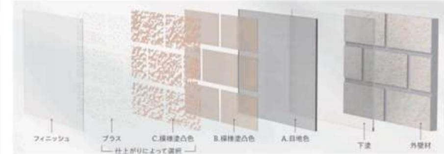
★トップはクリヤーで仕上げドレスアップアートフィニッシュの施工により顔料の露出を防ぐことで、美しい意匠をより長く維持します。さらに、塗膜表面の親水性能により、外壁を長期間清潔に保ちます。艶は2種類ご用意。
