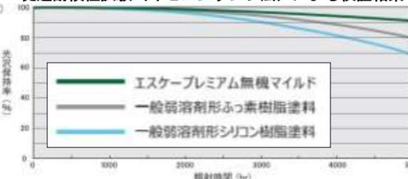
塗膜劣化の原因「ラジカル」を抑え、さらに無機成分の優れた剛性、有機樹脂の柔軟性を併せ持った塗膜を形成。躯体や基材等の下地を長期に亘って保護します。
